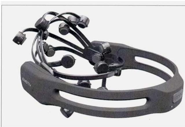
Bild 6. Tragbares EEG-Analysegerät zur Ermittlung emotionaler Zustände.
