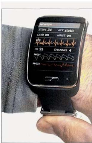
Bild 2. Das „Simband“ misst Blutdurchfluss, Blutdruck, Pulsrate, Körpertemperatur und Hautwiderstand. (Bild: Samsung)
